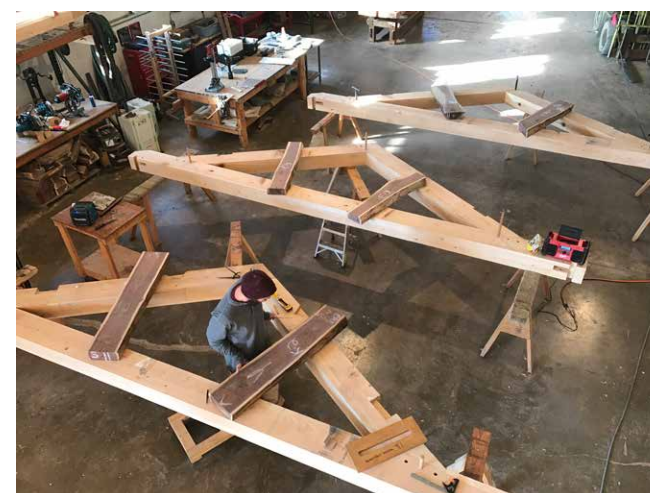
Här håller takstolarna på att bli skrejade, och som Jordan sa, så använde de "mill rule" för ramen men scribe rule för strävor. Och ganska så grova dimensioner (!)
