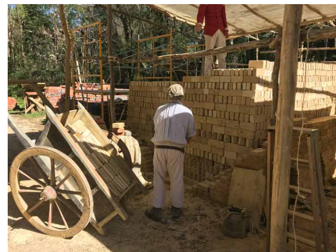
Murarlaget håller på att förbereda för bränning av tegelsten inne på området.
